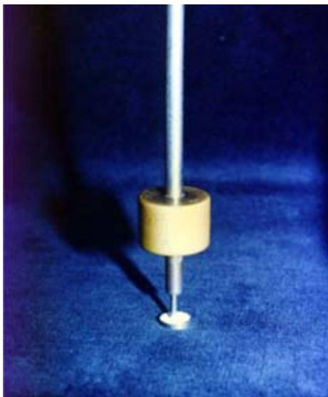
**Figura 7** - Simulação do teste de tempo de endurecimento, com a agulha de Gilmore posta sobre a amostra do material testado
