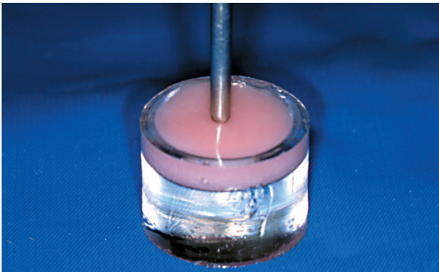
Figura 2 - Ponta romba em contato inicial com o material reembasador
