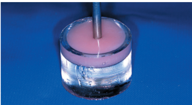
Figura 3 - Ponta romba durante o ensaio de penetração
