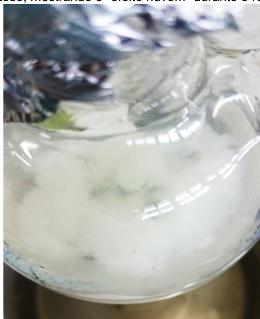
Figura 17 – Balão da síntese, mostrando o “efeito nuvem” durante o resfriamento da solução.
