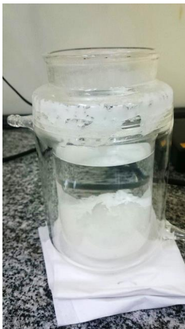
Figura 19 – Efeito da adição de água na separação do PVB por precipitação.
