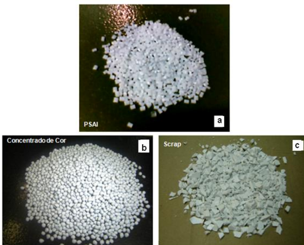
Figura 13 – Matérias-primas utilizadas no processo de extrusão das chapas, (a) PSAI, (b) Concentrado de cor e (c) Scrap (material reprocessado).
