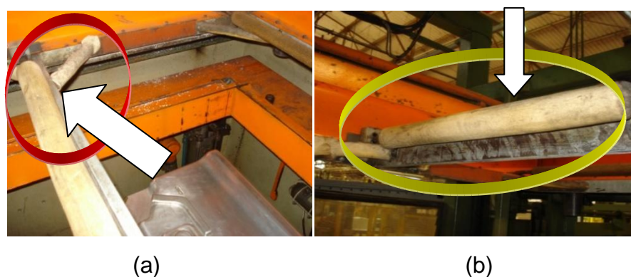
Figura 19 - Plugues conformadores de Feltro: (a) fixos e (b) rotativos.
