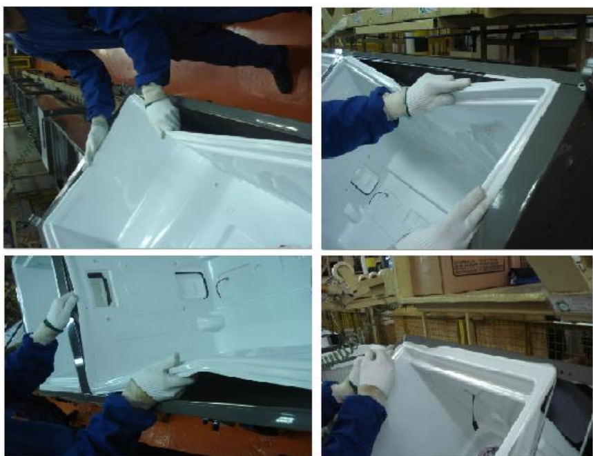
Figura 23 – Conformação e colocação da caixa interna no gabinete do refrigerador BRM 44.
