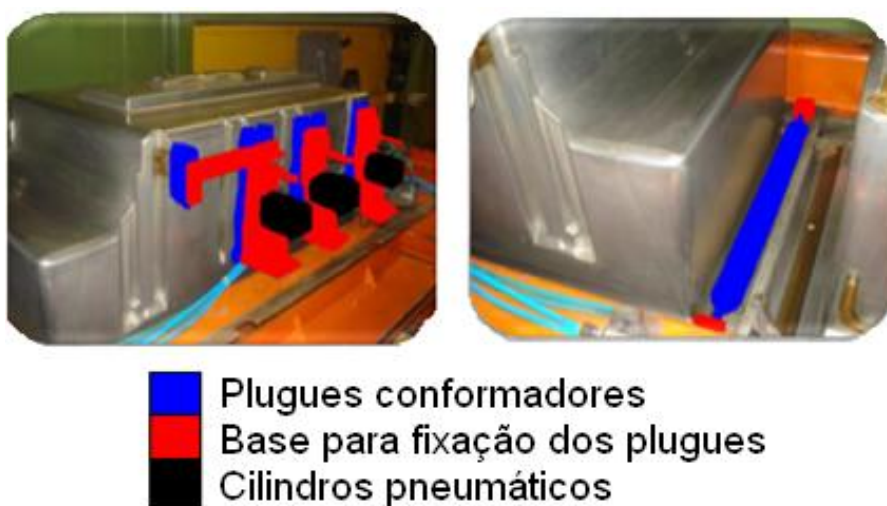
Figura 21 – Distribuição dos plugues acionados no molde.
