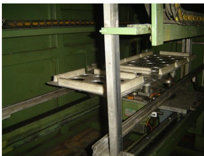
Figura 4 – Sistema de transporte da chapa plástica e da caixa interna conformada. Fonte: Primária (2010).
