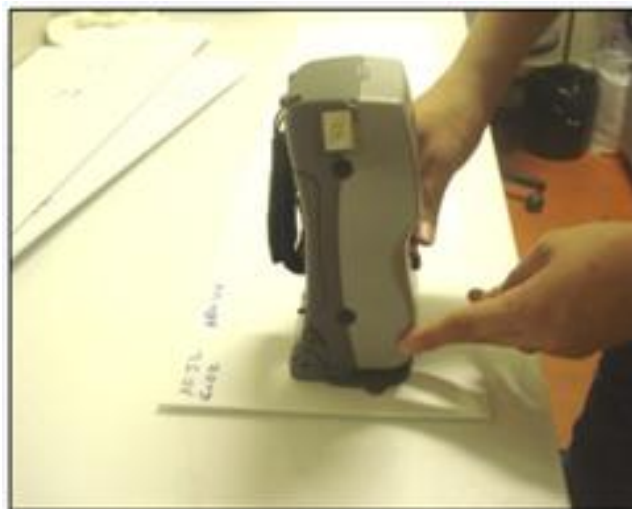
Figura 16 - Medida da cor da chapa em PSAI por colorímetro.
