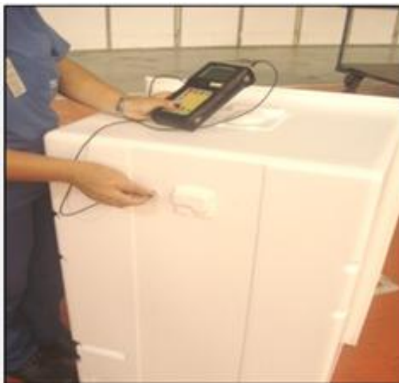
Figura 17 - Determinação da espessura da caixa interna por ultrassom.
