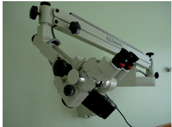
Figura 6 - Microscópio óptico DF Vasconcellos com câmera digital acoplada ao divisor de luz
