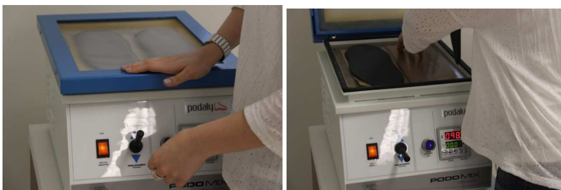
Figura 24 – Podomix. Equipamento utilizado na termocolagem colagem das palmilhas.
