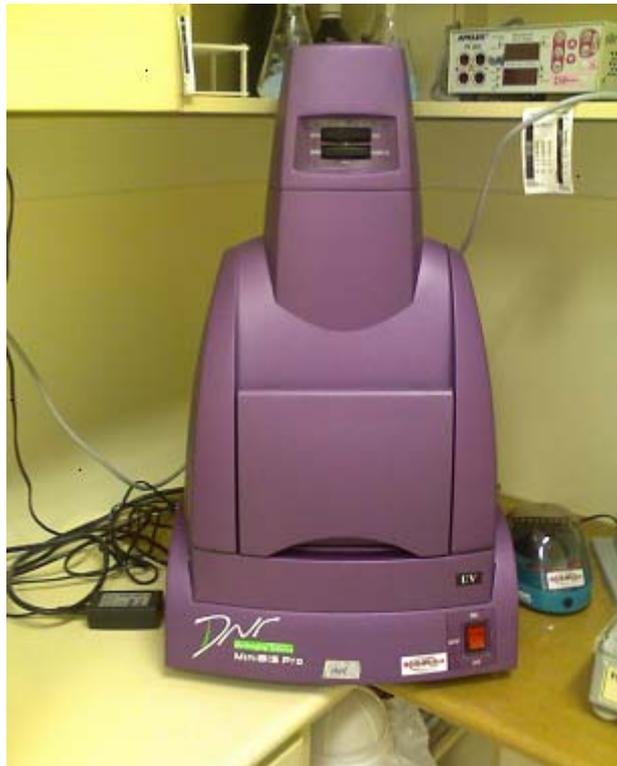
Figura 10 – Transiluminador MiniBis Pro da Bio-Imaging Systems
