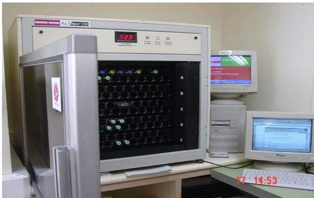
Figura 8 - Incubadora automática BacT/Alert® 120 do CHU/Joinville
