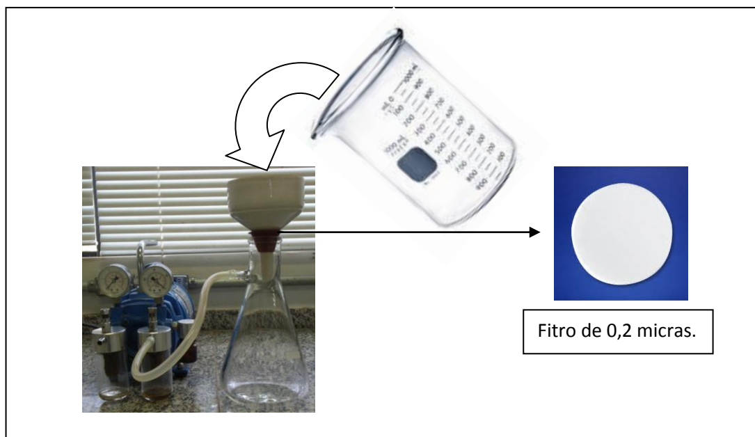
Figura 6. Filtragem da Solução Estoque utilizando bomba á vácuo e kitassato, com filtro de 0,2 \mu\text{m}
