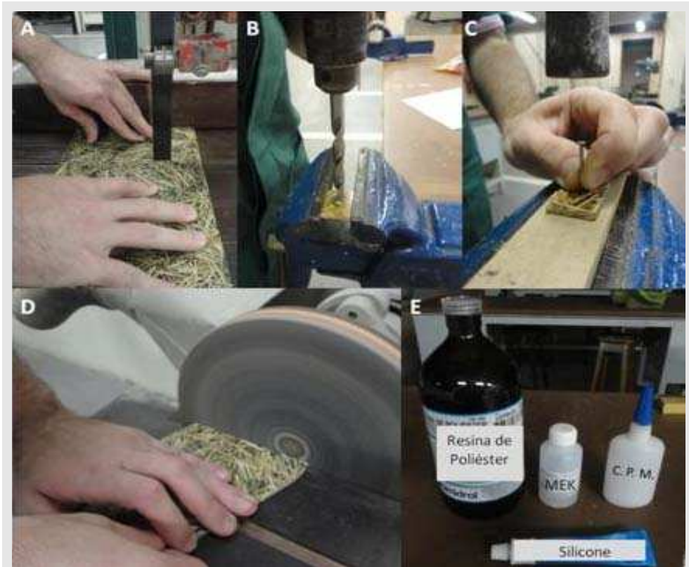
FIGURA 10 A – Corte em Serra de Fita; B – Perfuração com Broca em Furadeira Elétrica; C – Perfuração com Pregos; D – Polimento com Lixadeira Elétrica; E – Aglutinantes Utilizados; Fonte: Arquivo Pessoal
