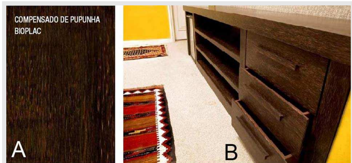
FIGURA 7 - A - Compensado de Pupunha (Bioplac) – B - Aparador Revestido com Compensado de Pupunha Fonte: Fibra Design Sustentável (2009, web)
