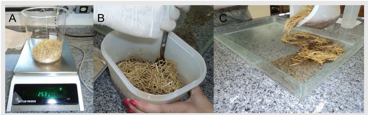
FIGURA 17 A – Pesagem do Material em Balança de Precisão; B – Homogeneização do Material em Recipiente Plástico; C – Depósito do Material no Molde de Vidro; Fonte: Arquivo Pessoal
