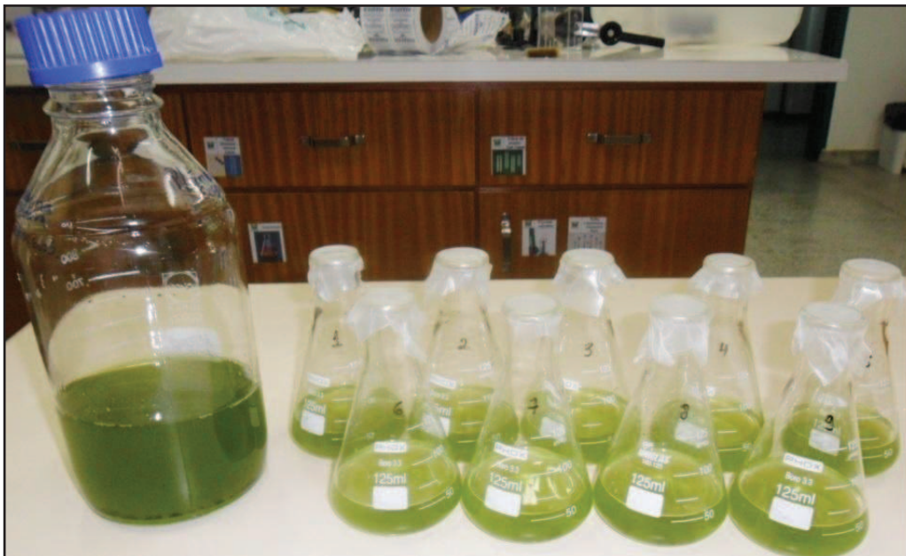
Figura 13: Teste de toxicidade crônica com Euglena gracilis . À esquerda observa-se o frasco contendo a cultura mãe contendo as algas, e à direita as algas em suas respectivas concentrações em g/L de sorbato de potássio. Fonte: Arquivo pessoal.
