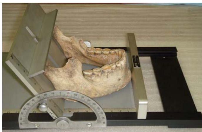
Figura 2: Aparelho de medição: mandibulômetro Fonte: MASJ
