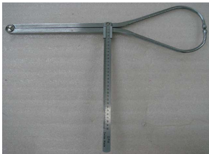
Figura 3: Instrumento de medição: paquímetro de espessura
