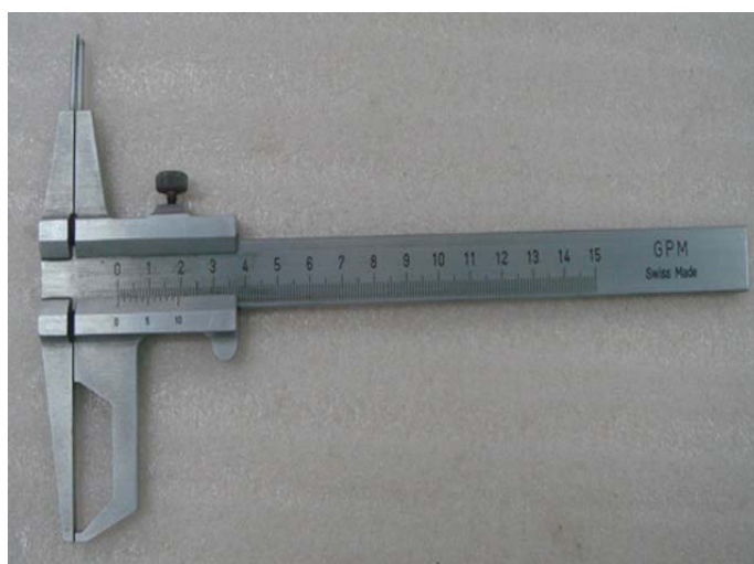
Figura 4: Instrumento de medição: paquímetro de corredeira
