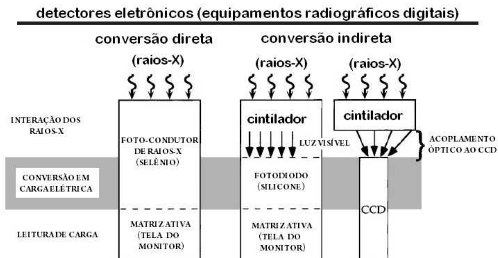
Figura 5: Formação da imagem em equipamentos radiográficos digitais: um processo mediado por detectores eletrônicos.
