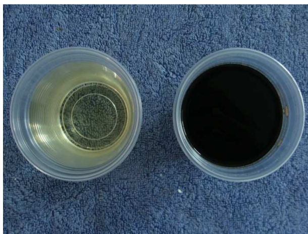
Figura 14: Solução reveladora virgem, A0 e em descarte: efeito da oxidação e foto-oxidação.
