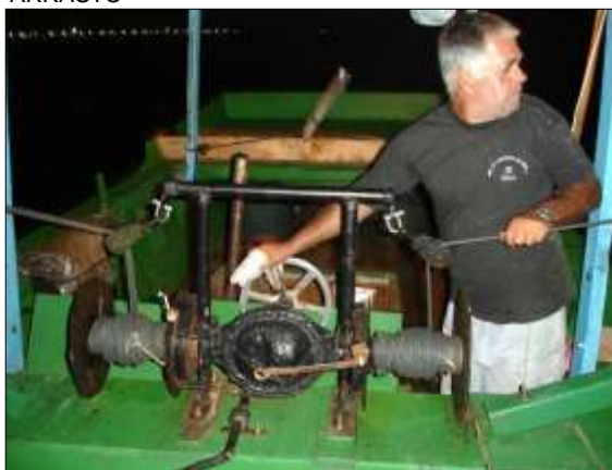
FIGURA 36- EMPREGO DE GUINCHO MOTORIZADO PARA RECOLHIMENTO DAS REDES APÓS O ARRASTO
